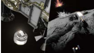
「はやぶさ2」搭載の衝突装置 (SCI) の切り離しのイメージ図。衝突装置運用の様子は分離カメラ「DCAM3」により観測し、探査機本体は小惑星から一時離脱する。©JAXA
