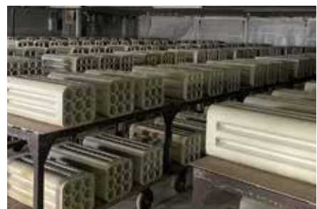
▲窯の炉熱を利用した陶管乾燥の様子
