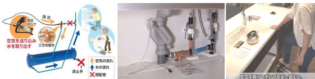
水槽周り配管の一例 流し台下部の操作弁及び足踏みポンプ〔メーカーHPより〕
