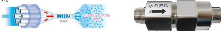
旋回流の仕組み概要図 ウルトラファインバブル発生器具（例） （メーカーHPより）
