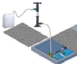
防災手動ポンプ
