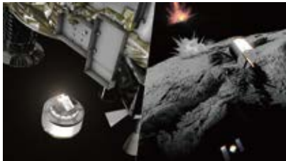
「はやぶさ2」搭載の衝突装置 (SCI) の切り離しのイメージ図。衝突装置運用の様子は分離カメラ「DCAM3」により観測し、探査機本体は小惑星から一時離脱する。©JAXA
